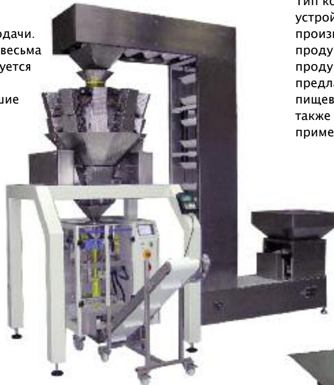
Мультиголовочные весы AVM 190 HS и загрузочный конвейер
